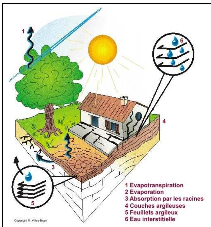
fig. 1 : illustration du mécanisme de dessiccation
