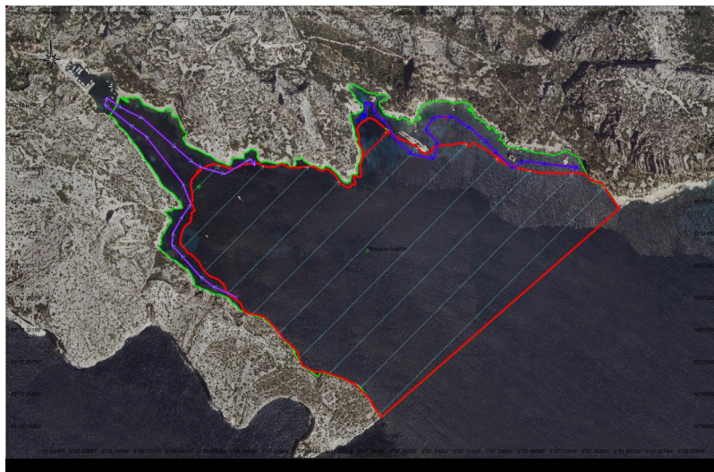
Figure 3 : Transects d'acquisition du sondeur à sédiment pour la calanque de Morgiou et Sugiton
