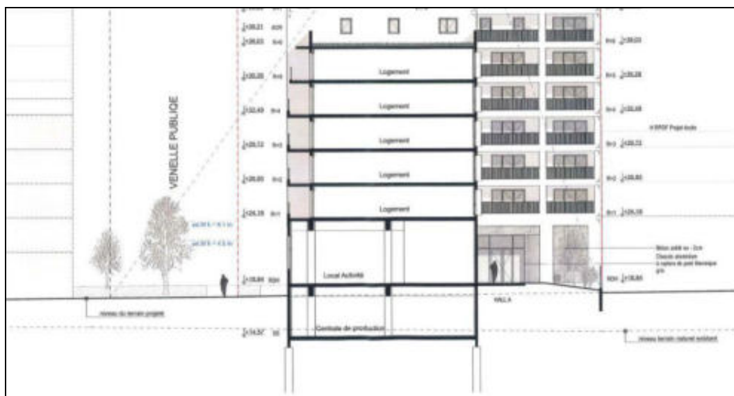
Figure 124 : Positionnement du bâti sur l'îlot 5B3a par rapport au terrain naturel (source : Linkcity, 2019)
