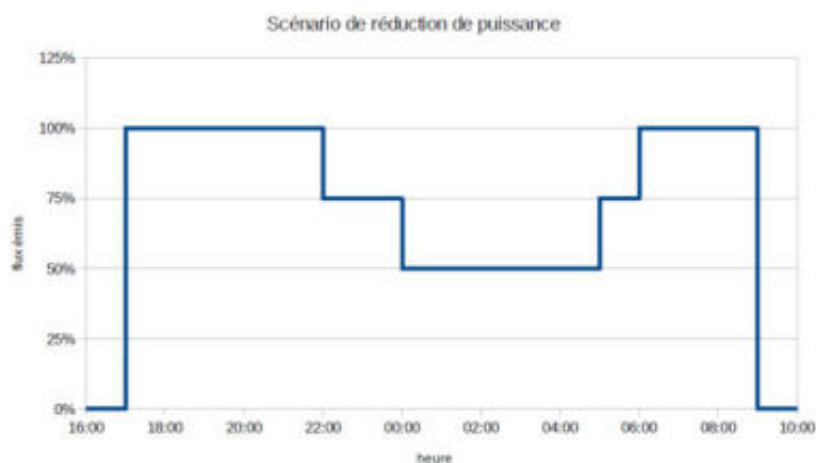
Figure 195 : Courbe de puissance de l'éclairage public en fonction de l'heure de la nuit
