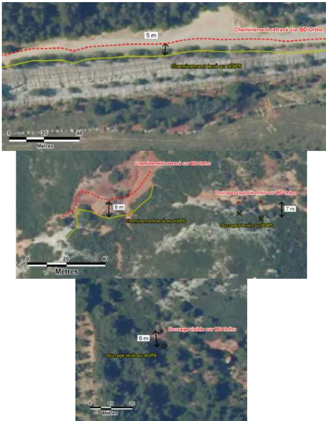
Figure 27 : illustrations des décalages entre les levés dGPS et BD-Orthoplan® (secteurs des Canonnettes, de Fangas et de Grand Méjean), INERIS
