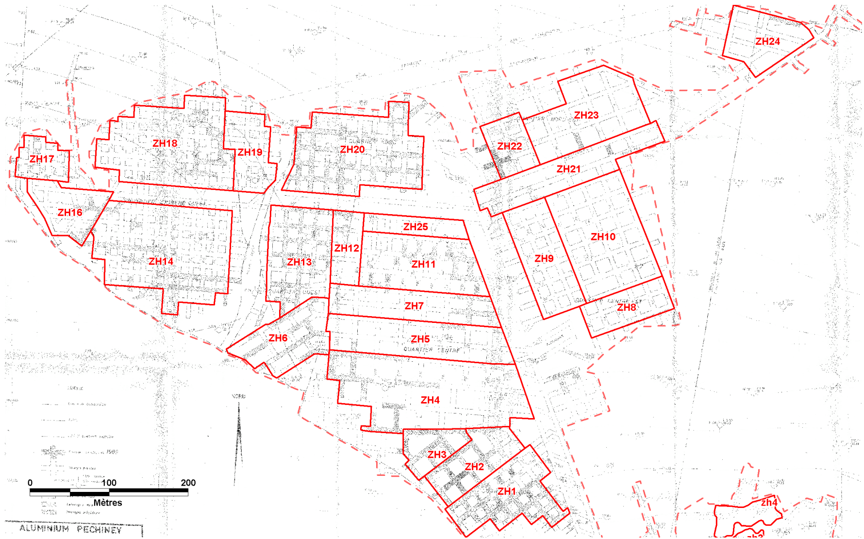
Figure 31 : zones homogènes de chambres et piliers de la Mine des Canonnettes, INERIS
