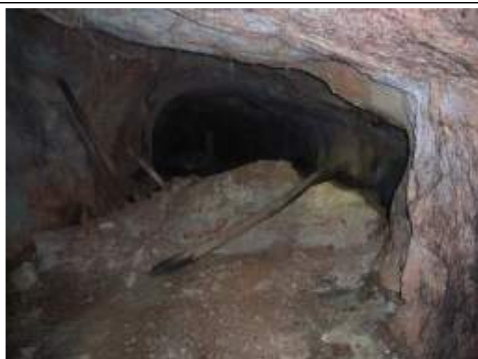
Chambres et piliers au pendage de la carrière souterraine de Mas Méjean
