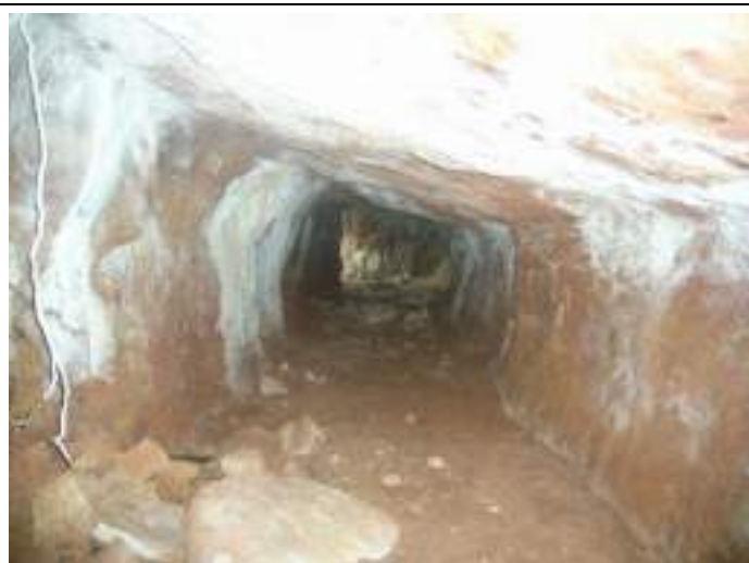
Chambres et piliers au pendage de la carrière souterraine de Mas Méjean
