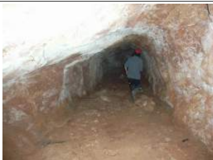
Chambres et piliers au pendage de la carrière souterraine de Mas Méjean
