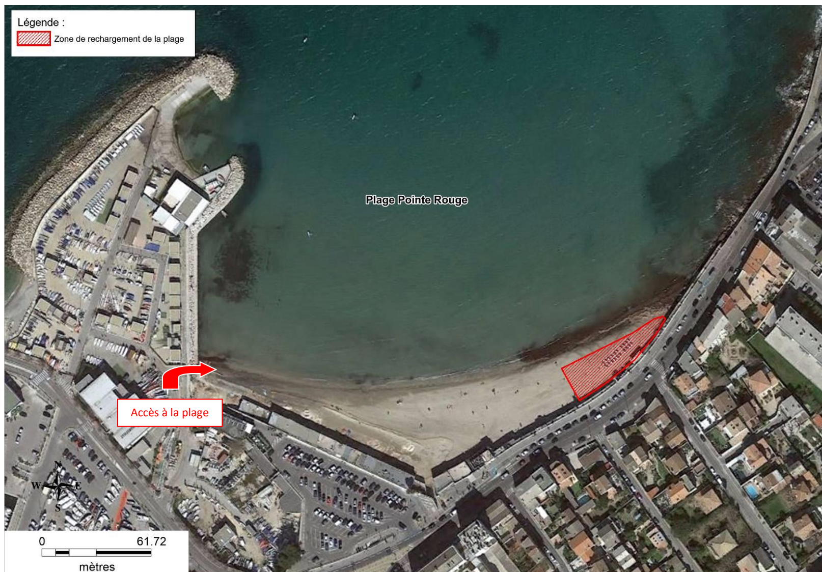
Le rechargement de la plage de la plage de la Pointe Rouge à partir des sédiments dragués dans le port de Malmousque
