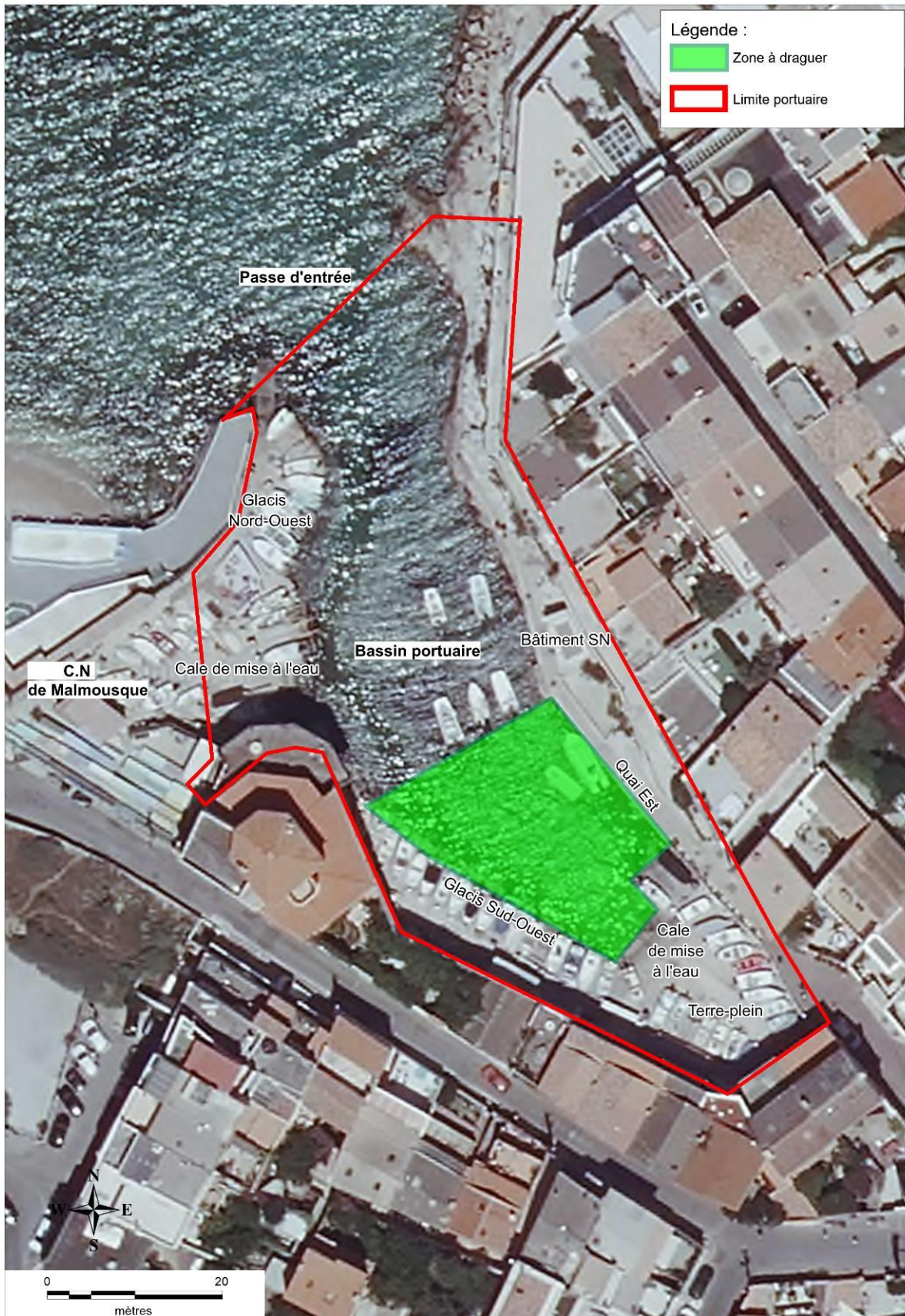
Figure 2 : Emprise maximale du dragage dans le port de Malmousque
