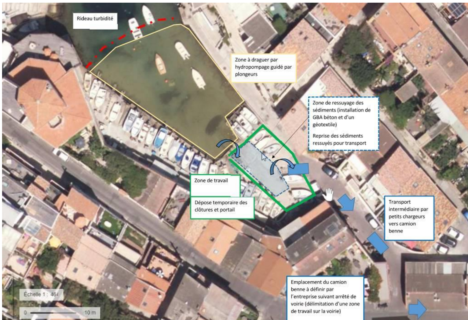
Figure 3 : Schéma de principe des travaux de dragage du port de Malmousque
